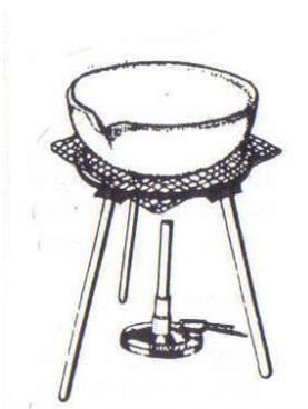
**Figura 2.** Calentamiento por la parte inferior de la cápsula.
