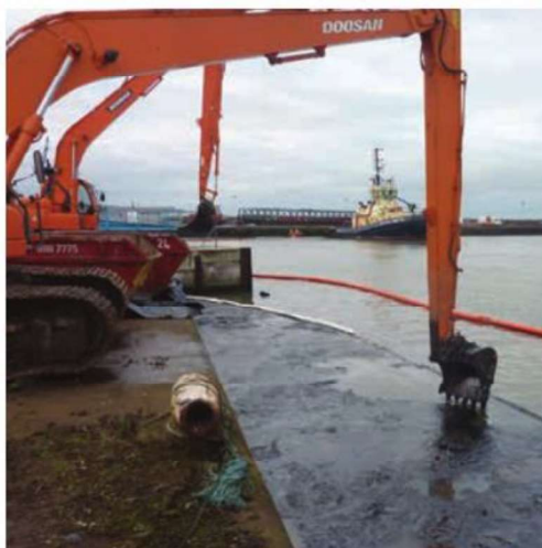
Figura 8. Recolección mecánica de hidrocarburos (ITOPF, 2011a)
