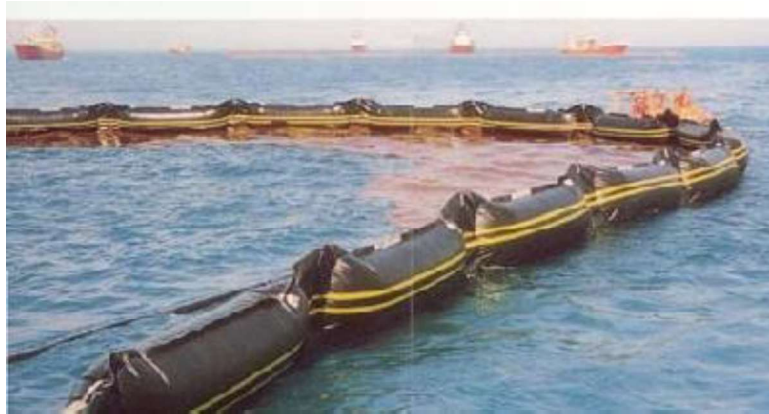
Figura 4. Funcionamiento de una barrera de contención (Ministerio de Agricultura, s.f.)
