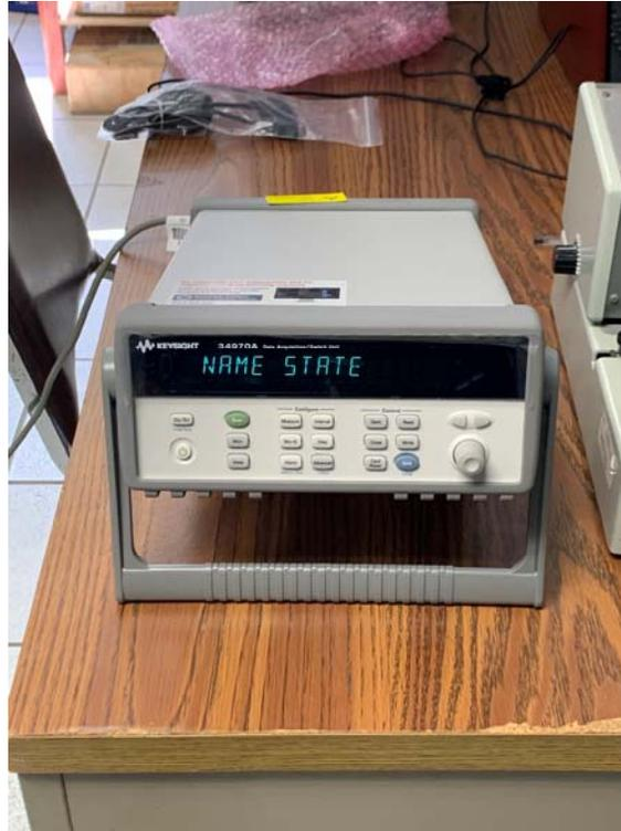
Figura 6. Sistema de adquisición de datos Keysight 34970A.
