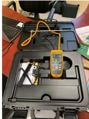
**Figura 2.** Anemómetro digital para medición de velocidad de viento, marca
